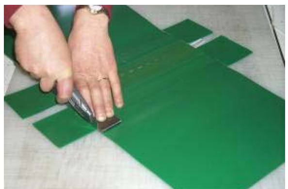
Begrenzungsplatten entfernen und Verbinder fertig stellen
