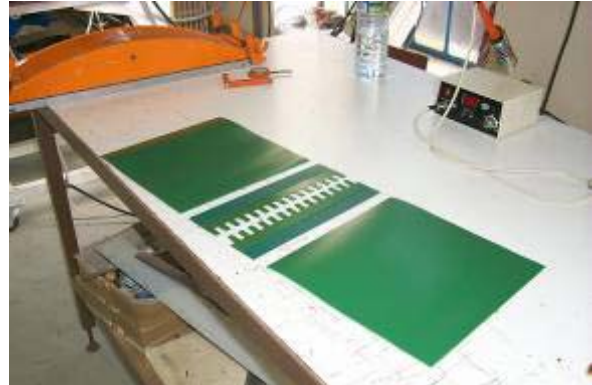
Verbinder entsprechend der Bandbreite abschneiden
