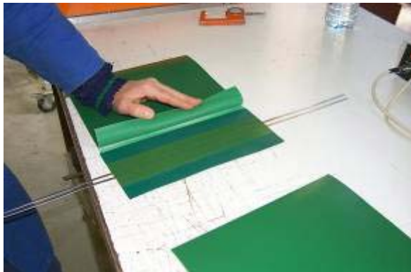
Verbinder platzieren und Metallstäbe einschieben
