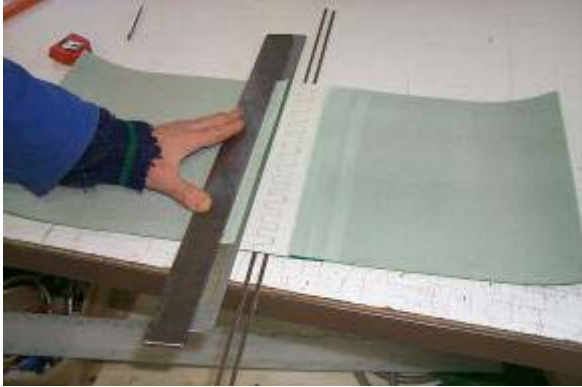
Unterste Textileinlage am Rand des Verbinders entfernen, dabei eine Metalleiste zum Schutz einlegen
