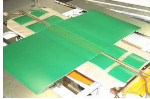
Verbinder mit Bandenden in Presse sowie Begrenzungsplatten (Bandreste) legen. Die Metallstäbe müssen über die Kühlung liegen
