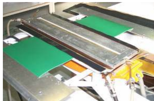
Obere Zwischenplatte mit Kühlsystem auf Verbinder legen
