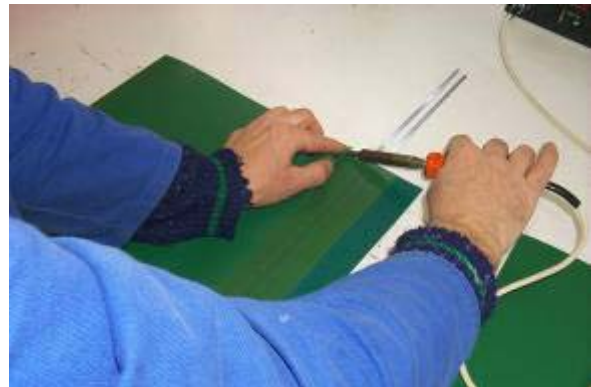
Verbinder mit LötKolben o. Leister an mehrere Stellen anheften
