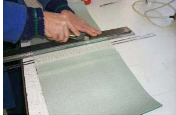
Unterste Textileinlage am Rand des Verbinders entfernen, dabei eine Metalleiste zum Schutz einlegen
